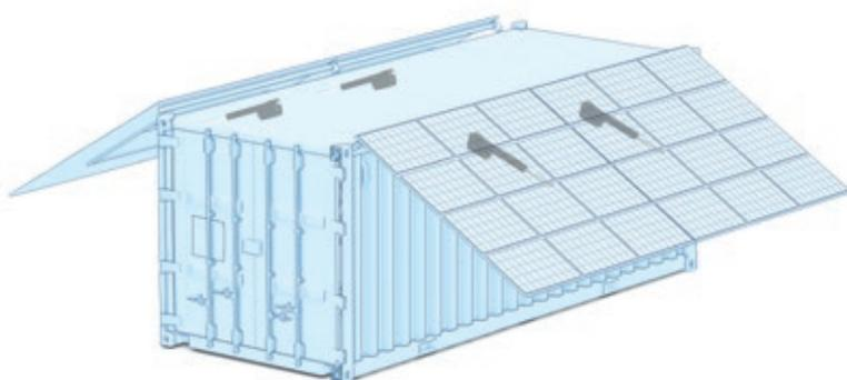
Le vérin Electrak HD est une solution industrielle capable de gérer des charges lourdes telles que de grands panneaux solaires dans des installations robustes. Ces charges lourdes, qui nécessiteraient normalement un soutien structurel et des solutions d'actionnement plus lourdes, peuvent être facilement soulevées par plusieurs vérins HD travaillant en synchronisation.
