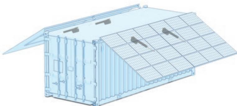
O Electrak HD é uma solução industrial que pode manusear cargas pesadas, como grandes painéis solares, em instalações robustas. Essas cargas pesadas, que normalmente exigiriam suporte estrutural e soluções de atuação maiores, podem ser facilmente elevadas com vários atuadores HD em sincronia.
