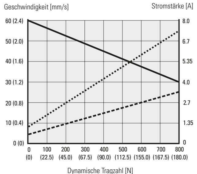
Geschwindigkeit ——— Strom bei 12 VDC ..... Strom bei 24 VDC - - - - -
