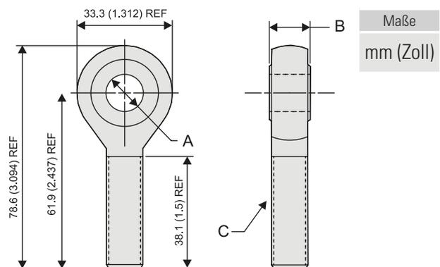
Der vordere Gelenkkopf-Adapter ist in metrischer und in Zoll-Ausführung erhältlich. Der metrische Adapter kann am vorderen Ende der Kolbenstange montiert werden, wenn der Aktuator mit dem optionalen metrischen Innengewinde-Adapter vorne (Typ P) ausgerüstet ist, während der Zoll-Adapter das optionale zöllige Innengewinde (Typ G) erfordert.
