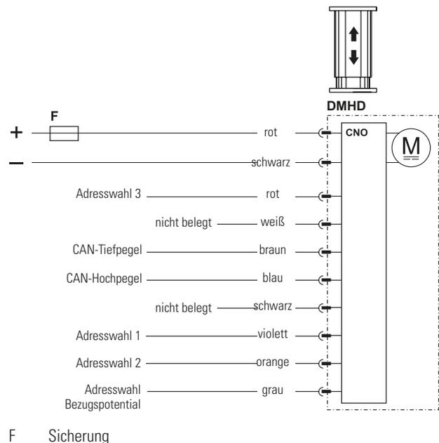
Zur Steuerungsoption CNO gehört eine SAE J1939 CAN-Bus-Steuerschnittstelle, zur COO eine CANopen-Steuerschnittstelle, die den Aktuator ansteuert und überwacht. Die Ein- und Ausfahrbefehle werden als CAN-Telegramme an den Pins „CAN-Tiefpegel“ und „CAN-Hochpegel“ ausgegeben. Die Adresswahl-Pins 1, 2 und 3 können als BCD-codierter Zusatz zur Standardadresse genutzt werden. Dies kann notwendig sein, wenn mehrere Aktuatoren am selben Bus angeschlossen sind.
