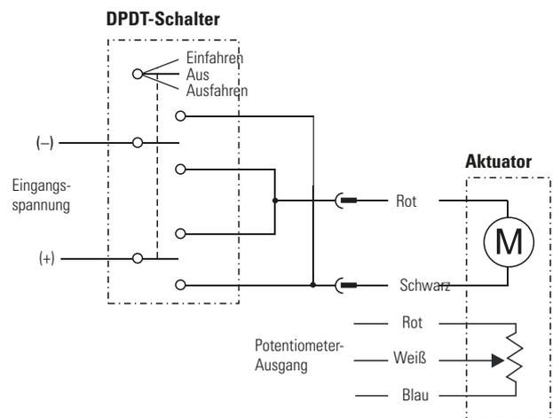
Verbinden Sie den schwarzen Leiter mit Plus und den roten mit Minus, um den Aktuator auszufahren. Tauschen Sie die Polarität, um ihn einzufahren. Am Potentiometer-Ausgang liegen 0 Ohm zwischen Weiß und Blau, wenn der Aktuator ganz eingefahren ist.
