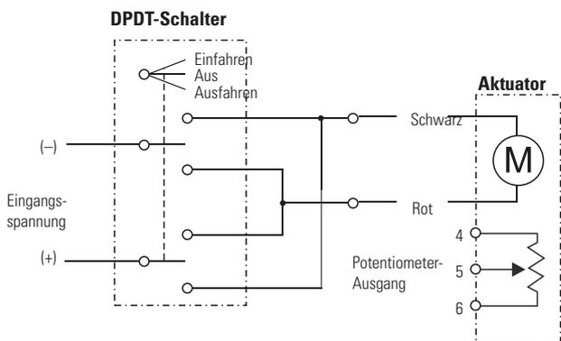
Verbinden Sie den schwarzen Leiter mit Plus und den roten mit Minus, um den Aktuator auszufahren. Tauschen Sie die Polarität, um ihn einzufahren. Am Potentiometer-Ausgang liegen 0 Ohm zwischen Klemme 4 und 5, wenn der Aktuator ganz eingefahren ist.
