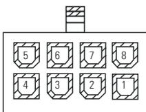
Verbinden Sie den grünen Leiter (Pin 4 ) mit Plus und den roten Leiter (Pin 8 ) mit Minus, um den Aktuator auszufahren. Tauschen Sie die Polarität, um ihn einzufahren.
