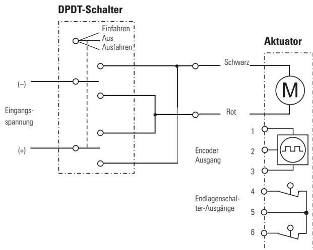
Verbinden Sie den schwarzen Leiter mit Plus und den roten mit Minus, um den Aktuator auszufahren. Tauschen Sie die Polarität, um ihn einzufahren. Der Encoder wird zwischen Klemme 1 und 3 gespeist; das Impulsfolgesignal wird an Klemme 2 erzeugt. Die Endlagenschalter-Ausgänge liegen an Klemmen 4 und 6; sie haben einen gemeinsamen Spannungseingang an Klemme 5.
