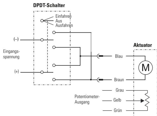
Verbinden Sie den braunen Leiter mit Plus und den blauen mit Minus, um den Aktuator auszufahren. Tauschen Sie die Polarität, um ihn einzufahren. Am Potentiometer-Ausgang liegen 0 Ohm zwischen Grau und Gelb, wenn der Aktuator ganz ausgefahren ist.
