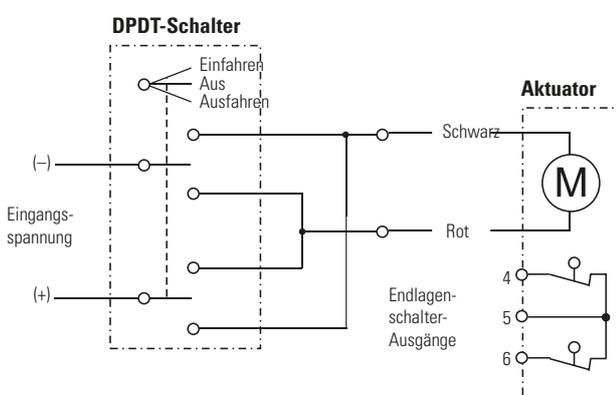
Verbinden Sie den schwarzen Leiter mit Plus und den roten mit Minus, um den Aktuator auszufahren. Tauschen Sie die Polarität, um ihn einzufahren. Die Endlagenschalter-Ausgänge liegen an Klemmen 4 und 6; sie haben einen gemeinsamen Spannungseingang an Klemme 5.
