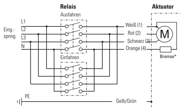
Die Leiter sind farbcodiert oder nummeriert. Verbinden Sie den weißen Leiter (1) mit L1, den roten (2) mit L2 und den schwarzen (3) mit L3, um den Aktuator auszufahren. Vertauschen Sie Weiß (2) und Schwarz (3), um den Aktuator einzufahren. Hat der Aktuator eine Nachlaufbremse\*, muss diese während der Bewegung gelöst werden, indem Orange (4) auf N (Nullleiter) geschaltet wird.
