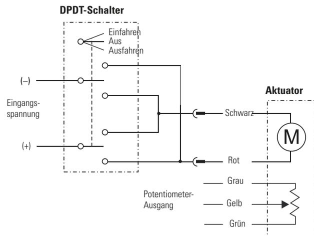
Verbinden Sie den roten Leiter mit Plus und den schwarzen mit Minus, um den Aktuator auszufahren. Tauschen Sie die Polarität, um ihn einzufahren. Am Potentiometer-Ausgangskabel liegen 0 Ohm zwischen dem grauen und gelben Leiter, wenn der Aktuator ganz ausgefahren ist.
