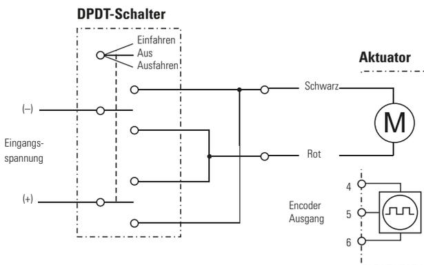
Verbinden Sie den schwarzen Leiter mit Plus und den roten mit Minus, um den Aktuator auszufahren. Tauschen Sie die Polarität, um ihn einzufahren. Der Encoder wird zwischen Klemme 4 und 6 gespeist; das Impulsfolgesignal wird an Klemme 5 erzeugt.
