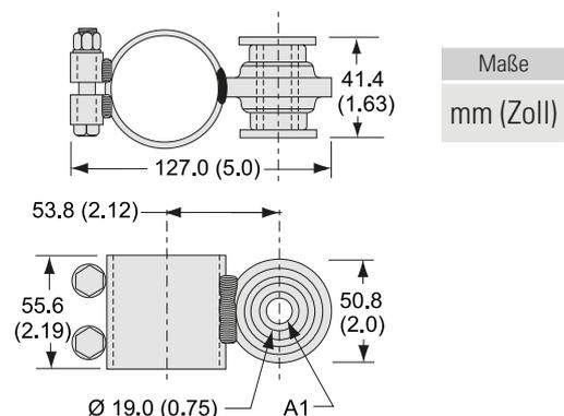
A1: Bohrungsdurchm. 12,7 mm mit Lagerbuchse.
