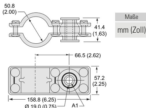
A1: Bohrungsdurchm. 12,7 mm mit Lagerbuchse.
