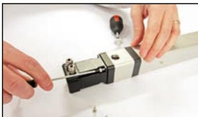
Serrez les vis de montage du moteur
