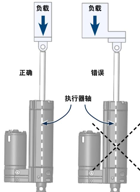
负载应沿执行器轴产生作用力。偏心负载可能会导致执行器相互卡住并引起设备过早故障。
