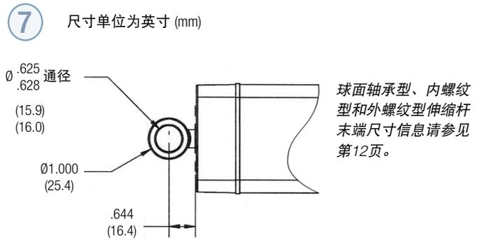
**8 A型标准伸缩杆末端的伸缩杆直径**
