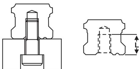
Eine Verschraubung der Schiene von ergibt eine glatte Oberfläche ohne Öffnungen, in denen sich Schmutz oder andere Partikel ansammeln können.
