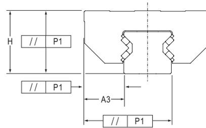
Die Laufparallelität beschreibt die Toleranz für H und A3 in Bezug auf den Axialverfahrweg und wird von einem Schlitten über die ganze Schienenlänge gemessen. Dieses Maß entspricht der Geradheit des Verfahrwegs. Die Parallelität als solches beschreibt nur die Eigenschaften der Schiene.
