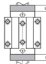
L1 = Stärke der Schmierplatte, Schraubenköpfe sind in Platte versenkt
