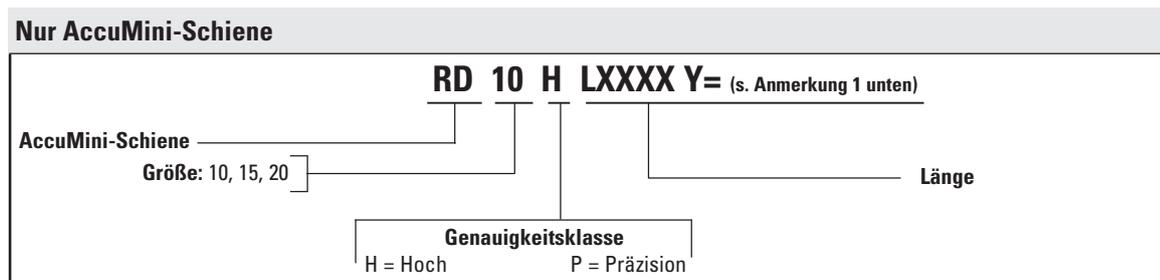
1. Y = Abstand vom Schienenende bis zur Mitte der 1. Montagebohrung
