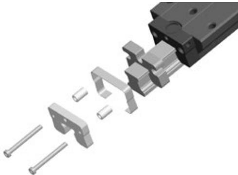
Das optionale Selbstschmiermodul ermöglicht einen wartungsfreien Betrieb und bietet zusätzlichen Schutz für eine breite Anwendungspalette. Vorteile:
