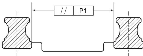
Tabelle 1: Parallelität zwischen mehreren Schienen, mm
