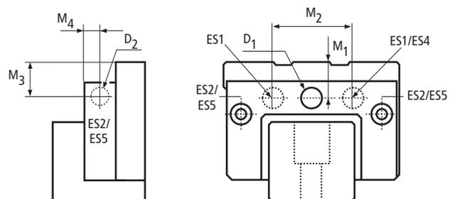
1. D1 und D2 sind Gewindebohrungen im Abschlussstück, um die Dichtigkeit und Dauerhaftigkeit der Verbindung zu gewährleisten.
