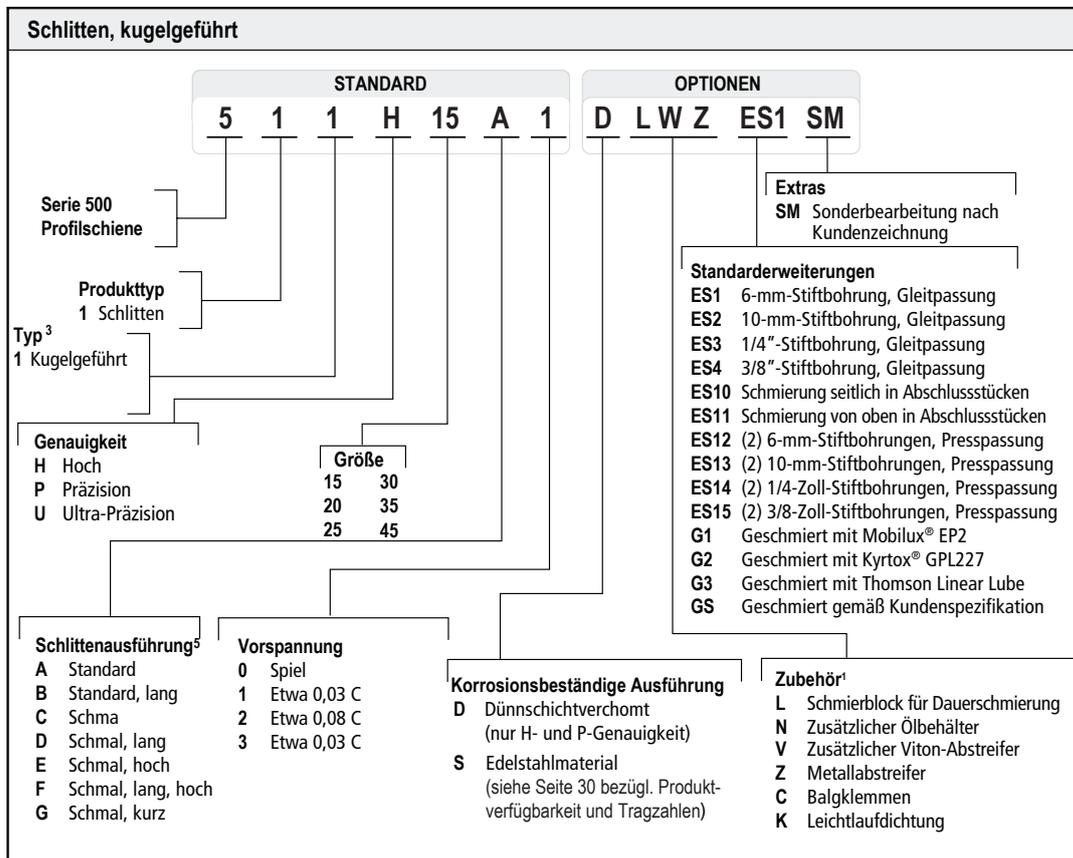
1. Zubehörkombinationsteilenummern sind vom Abschlussstück des Schlittens ausgehend aufgeführt. Nicht alle Kombinationen sind verfügbar. Zur Verfügbarkeit bestimmter Kombinationen siehe Seiten 40-41.
