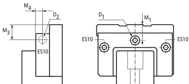
1. D1 und D2 sind Gewindebohrungen im Abschlussstück, um die Dichtigkeit und Dauerhaftigkeit der Verbindung zu gewährleisten.
