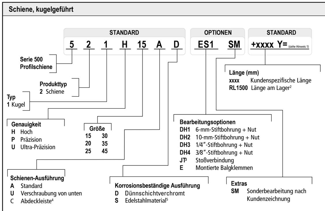
1. Y = Abstand zwischen Schienenende und Mitte der ersten Montagebohrung.
