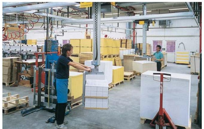
将汤姆森的高架导轨与直线升降装置结合起来，可以满足任何材料搬运需求。我们提供预先配置好的升降装置以及特有的部件，您可以将它们方便地组合起来以满足自己的需求。
